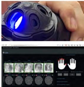
Especialmente diseñada para la identificación biométrica en recién nacidos, esta solución integra SmartScan® WEBPLUS con un dispositivo especial que captura la información biométrica dactilar y un mecanismo de escalamiento y ajuste de la imagen, basada en AI, posibilitando la utilización de dichos datos en sistemas de identificación automática (ABIS).
