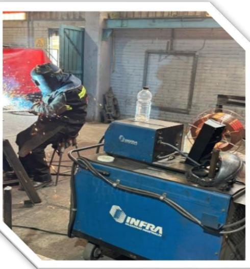
**DESCRIPCIÓN:** El proceso de soldadura GMAW (Gas Metal Arc Welding), también conocido como soldadura MIG/MAG, es un método de unión de metales que utiliza un arco eléctrico entre un electrodo consumible y la pieza de trabajo, protegido por un gas de protección.
