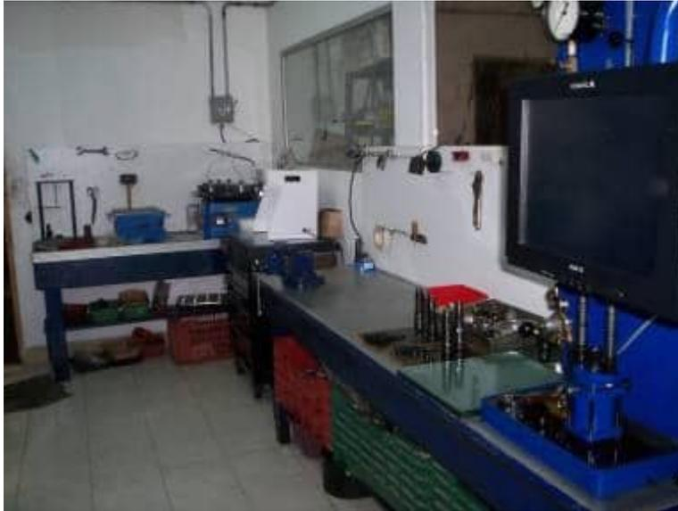
*Tina de lavado de ultrasonido, burbuja de prueba de inyectores
