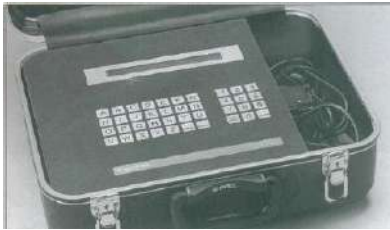
MALETA DE PRUEBAS PARA LAS UNIDADES DE PROTECCION SB – TL DE INTERRUPTORES SIEMENS
