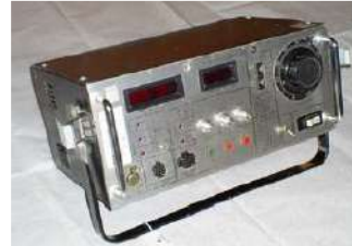
MALETA DE PRUEBAS PARA LAS UNIDADES DE PROTECCION SD – 3 Y SD – 6 DE INTERRUPTORES H – 2 Y H – 3 DE FEDERAL PACIFIC
