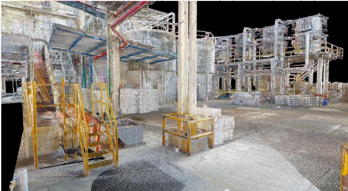
Ilustración 1. Levantamiento con nube de puntos para planta de fabricación de papel 7,105 m2 Tlaxcala 2026
