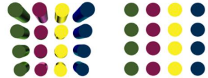
Izquierda: óptica no telecéntrica Derecha: óptica telecéntrica
