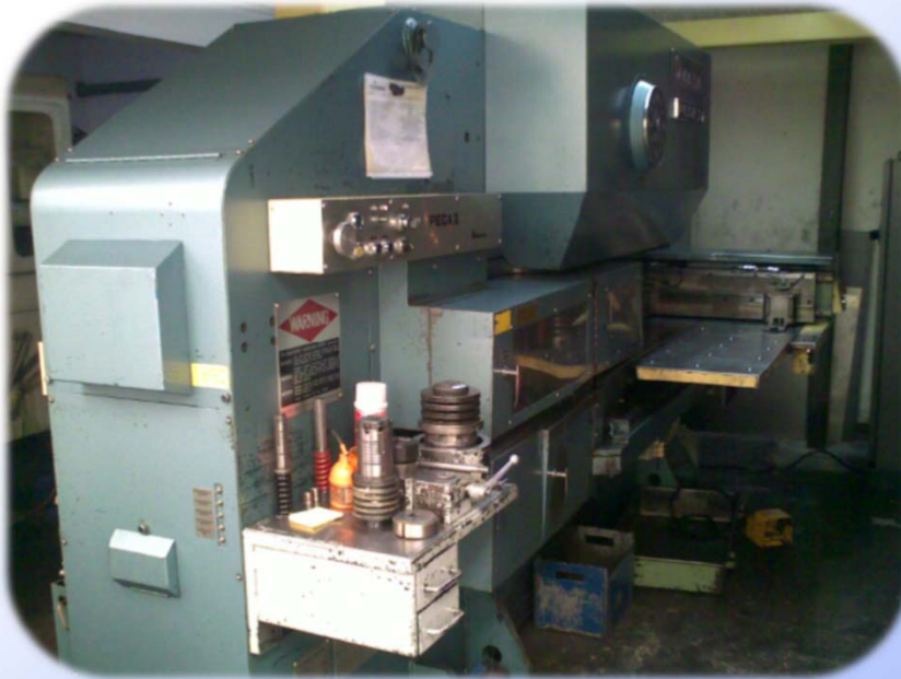
Punzonado Punzonado de control numerico 30 tons.
