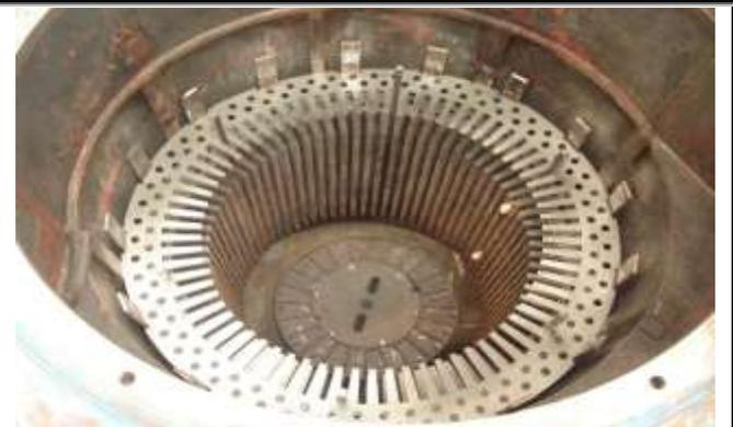
PROCESO DE TRASLAPE DE LAMINACION EN ESTATOR DE MOTOR
