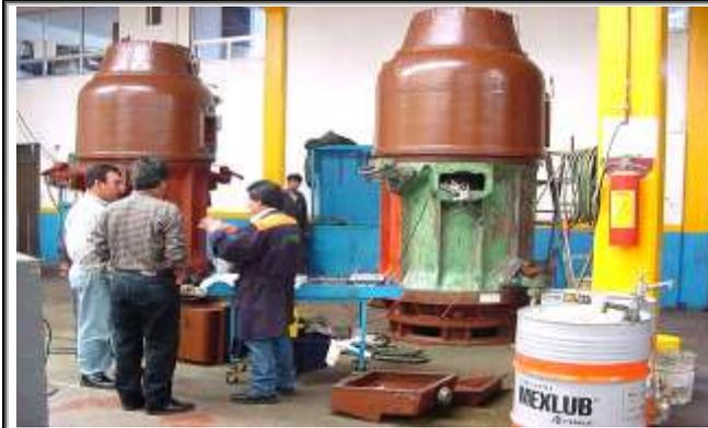
PRUEBAS DE ROTACION EN VACIO A TENSION PLENA. 4160 VOLTS.
