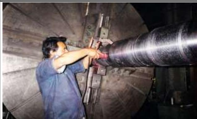
PROCESO DE FABRICACION Y MAQUINADO DE FLECHA NUEVA, SE REALIZA INSPECCION DE PARTICULAS MAGNETICAS, ASÍ COMO APLICACIÓN TECNICA DE ULTRASONIDO EN LA FLECHA, TANTO EN FORMA RADIAL COMO AXIAL, RESULTADOS ACEPTABLES.
