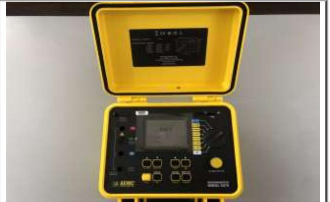
**MEDIDOR DE RESISTENCIA DE AISLAMIENTO (MEGÓHMETRO)**
