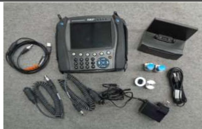
**ANALIZADOR COLECTOR AVANZADO DE DATOS (MICROLOG)**
