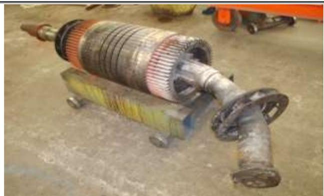
**DESARMADO Y DIAGNOSTICO DE FALLA; SE OBSERVA SEVERAMENTE DAÑADA LA FLECHA.**
