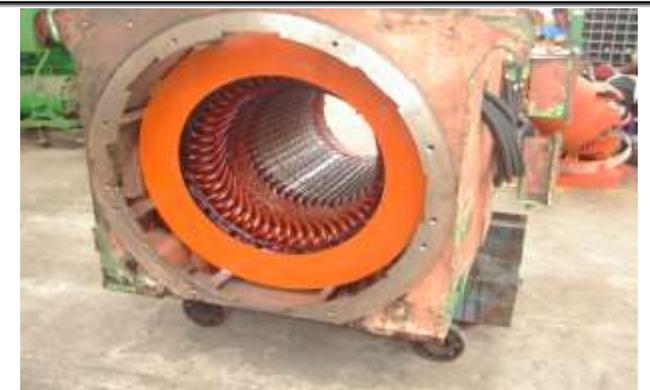
EMBOBINADO, BARNIZADO Y HORNEADO DEL ESTATOR
