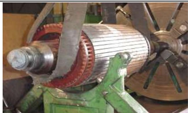
PROCESO DE EXTRACCION DE FLECHA DAÑADA
