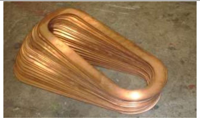
**FABRICACION DE BOBINAS PRINCIPALES TIPO CERCHA,
