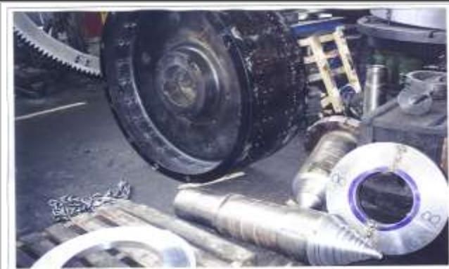
LIBERACIÓN DE FLECHA DAÑADA EN MASA DEL ROTOR, MOTOR SINCRONO DE 2500 HP
