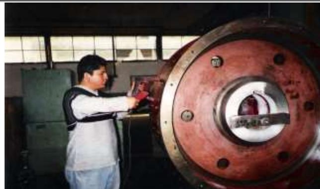
INSPECCION CON PARTICULAS MAGNETICAS SOBRE LA SUPERFICIE EXTERIOR DE LA MASA DEL VENTILADOR.
