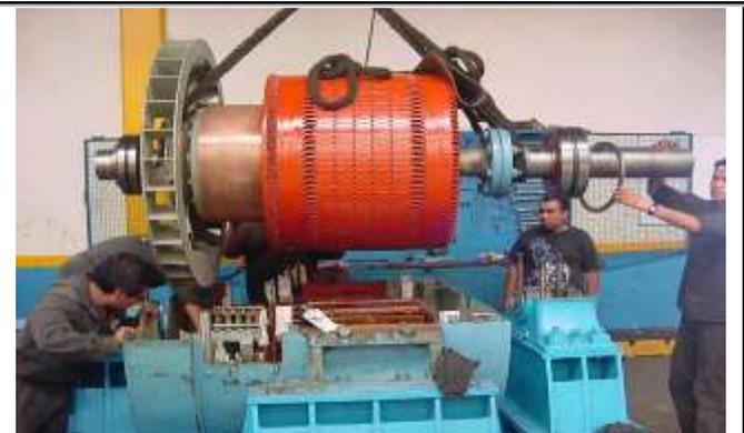
ENSAMBLE DE MOTOR ELÉCTRICO DE C.D. DE 600 KW.
