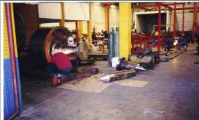
CONCLUYE FABRICACION Y MAQUINADO DE FLECHA NUEVA DE ACERO AL CARBON EN MASA DEL ROTOR.
