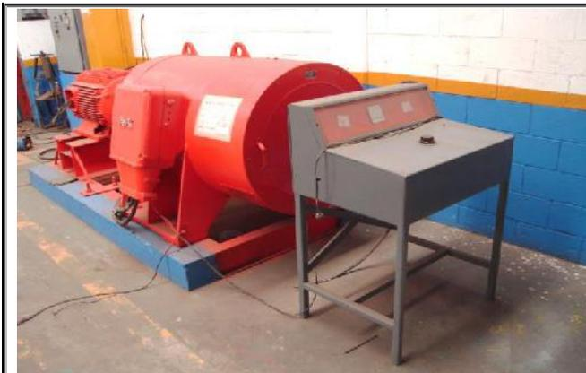
**GENERADOR DE CORRIENTE DE ALTA TENSION MOD. AVK,
