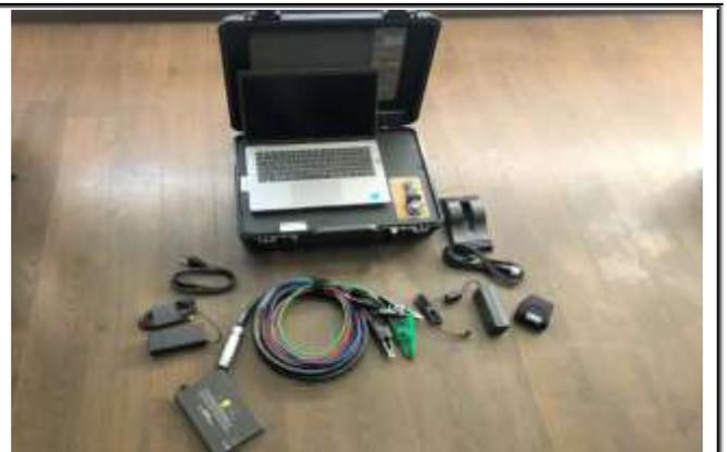
**EQUIPO PROBADOR DE MOTORES PDMA (ANÁLISIS DE MOTORES ELÉCTRICOS)
