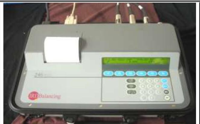
**BALANCEADORA DE SOPORTES FLEXIBLES C/ BALANCEADOR DEDICADO AUTOMATICO IRD BALANCING IRD 246**
