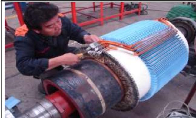
PROCESO DE EMBOBINADO DE ARMADURA DE MOTOR DE C.D.
