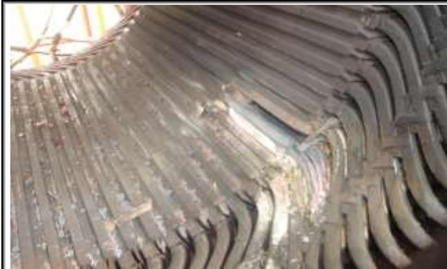
EMBOBINADO CON FALLA DE CORTO A TIERRA Y EXISTENCIA DE
