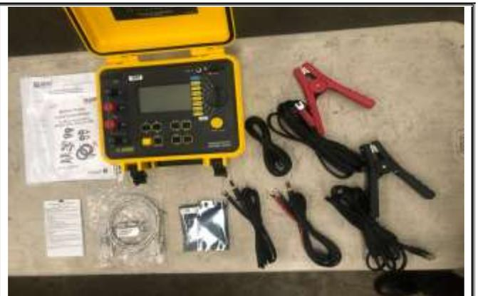
**MICRO-OHMÍMETRO DIGITAL DE RESISTENCIA DE CONTACTO.**
