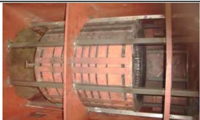
**FABRICACION DE BARRAS Y COLOCACION DE NUCLEO LAMINADO DEL ESTATOR.**
