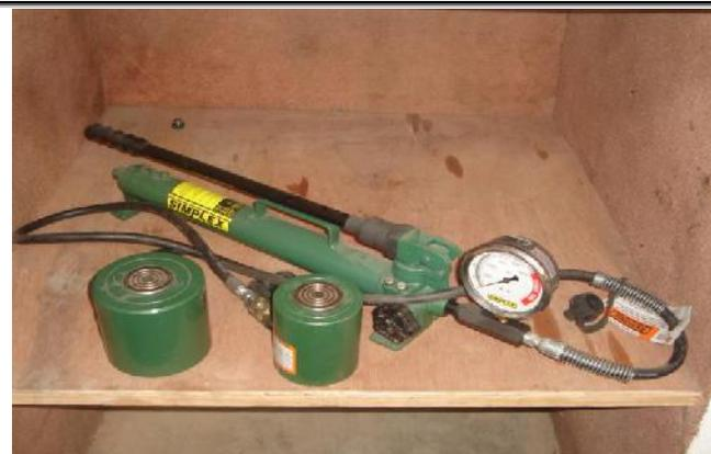
PORTA-POWER CON CILINDROS HIDRAULICOS EMBOLO SOLIDÓ CAP. 30 TON Y 50 TON. MODELO RLS-302 y RLS-502
