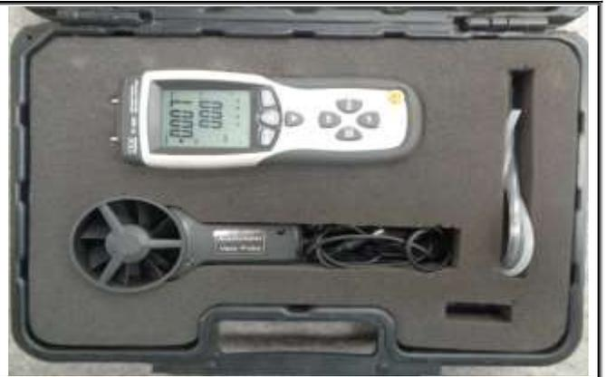
**(ANEMOMETRO) MANOMETRO DE PRESION Y MEDIDOR DE FLUJO**
