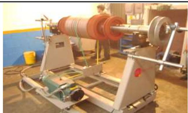
BALANCEO DINAMICO DEL ROTOR CON GRADO DE CALIDAD G2.5
