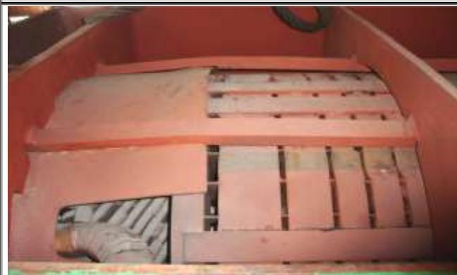
**SE OBSERVA BARRAS DE FIJACIÓN DEL NUCLEO SEVERAMENTE DAÑADAS (8), DEBIDO AL ESFUERZO MECANICO.**
